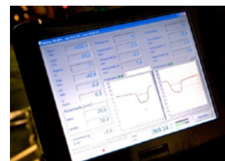
Leistungsfähige Schienenscanner unterstützen die Beurteilung und Ableitung der Korrekturmaßnahmen
