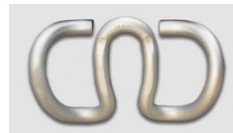
Die unversehrte Spannklemme nach 1.440 Stunden im Salzsprüh-test gemäß ISO 9227 NSS.
