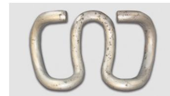
Spannklemme nach vorsätzlicher Schichtverletzung und 1.440 Stunden Salzsprüh-test gemäß ISO 9227 NSS zur Verdeutlichung des kathodischen Korrosionsschutzes.
