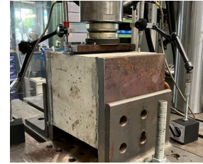
Die hohe Abscherfestigkeit der Besohlungen hat die Technische Universität München geprüft
