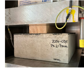
Die während des Tests zur Stapel-lagerungsfähigkeit aufgebrachte Last entspricht dem Gewicht von 15 besohnten Betonschwellen
