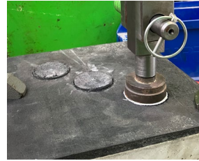
Das Prüfen der Abreißfestigkeit der Anbindeschicht sichert die dauerhafte Verbindung zum Beton
