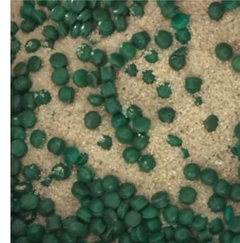
Zur Herstellung von *amalentic*-Komponenten wird das Polymer geschmolzen und mit dem Füllstoff sowie den Additiven homogen vermischt. Dann wird das Material in die benötigte Form gebracht, verpresst und abgekühlt. Die kontinuierliche Überwachung des gesamten Fertigungsprozesses garantiert die gleichbleibend hohe Qualität.
