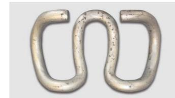
Spannklemme nach vorsätzlicher Schichtverletzung und 1.440 Stunden Salzsprüh-test gemäß ISO 9227 NSS zur Verdeutlichung des kathodischen Korrosionsschutzes.
